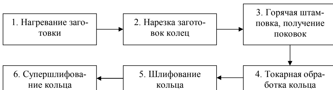
Рис. 3. Операции участка производства колец подшипника
