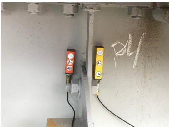
Рис. 1. Расположение тензометрических датчиков на стенке главной балки у верхнего конца вертикального ребра жесткости
